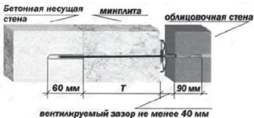
Рисунок 22 - Схема установки гибких связей для утепления и облицовки монолитной стены
