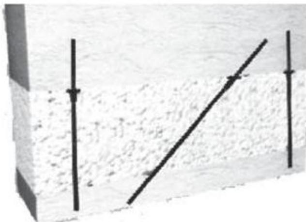
Рисунок 26 - Схема установки гибких связей для трехслойных панелей типа «сэндвич»
