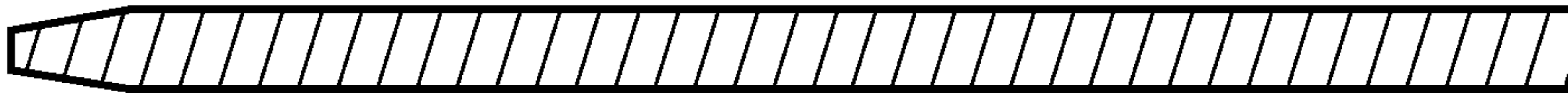
Рисунок К.3 — Композитная гибкая связь с выделенным анкерным участком под анкерную гильзу
